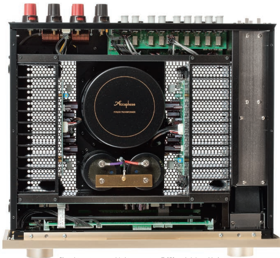
Charakterystyczna architektura wnętrza E-650 – właściwy układ odsunięto od jednego z boków, gdzie przygotowano miejsce na moduły rozszerzeń.
